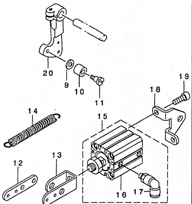
12. RHEIN1903S $\triangle$ -30 $\triangle$ : WIPER MECHANISM COMPONENTS
